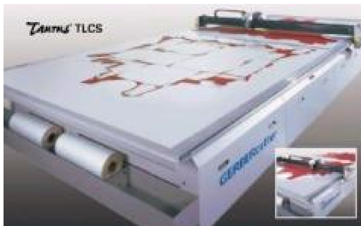
Рис. 6. Процесс автоматизированного раскроя натуральной кожи
